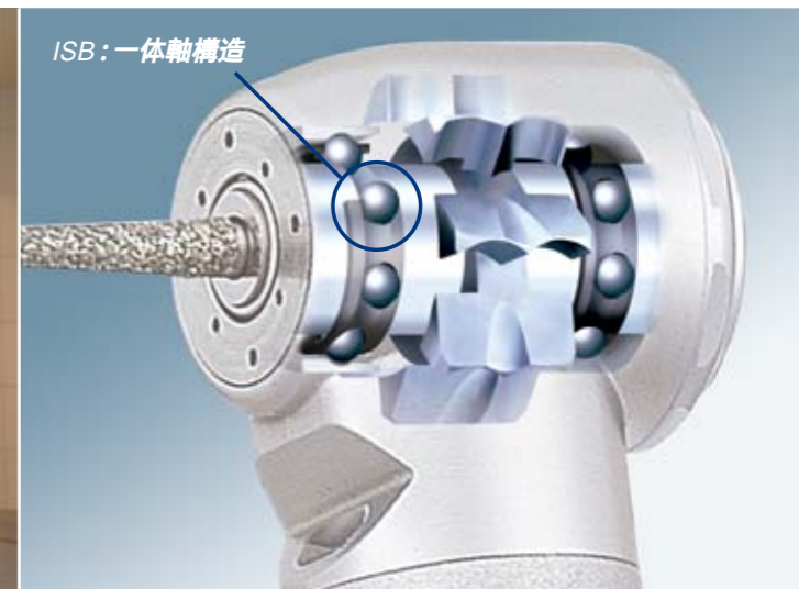
ISB (Integrated Shaft Bearing)は、回転軸上に溝を作りボールベアリングを直接走らせる一体軸構造にすることで、芯ブレ精度の向上と優れた静寂性を実現しています。
