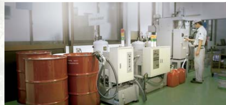
切削油精密濾過装置 切削油のリサイクル率97%を実現。
